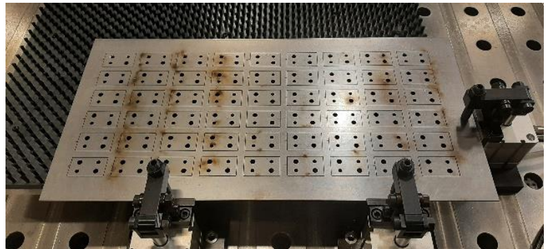
Kleinteile mit Microjoints
